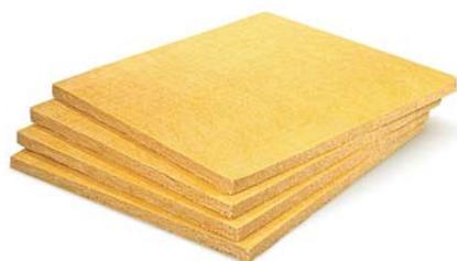
ISOTEC Tank slab GW40 применяется в качестве теплоизоляции вертикальных поверхностей емкостей (в т. ч. резервуаров для хранения воды, нефти, нефтепродуктов) и технологического оборудования (в т. ч. и криволинейных поверхностей радиусом более 250 мм), установленных внутри помещений.
